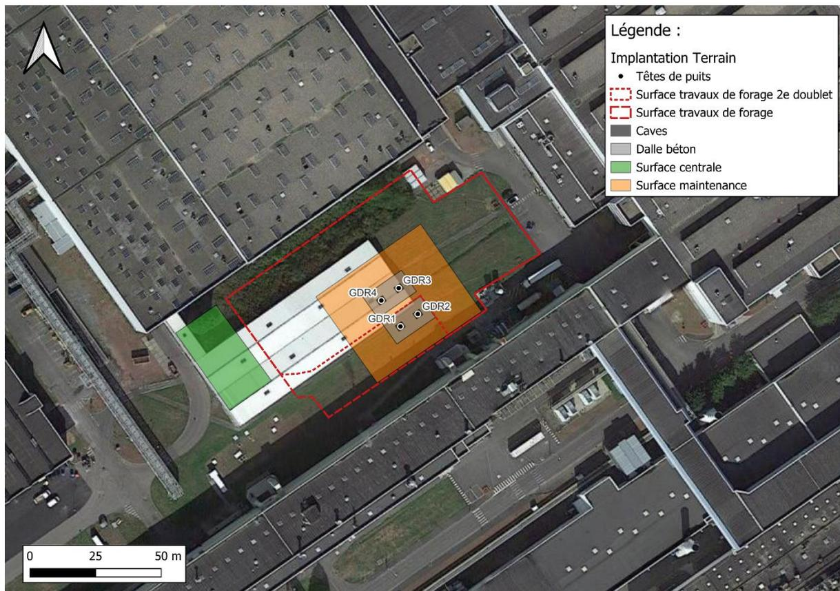
**Figure 6 : Implantation des têtes de puits sur le site de l'usine Renault**
